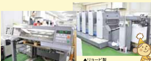
▲インキを入れてこれから印刷。▲リコー製LED-UV速乾印刷機
